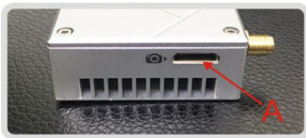
A: 1* Mini HDMI Port on TX & RX
